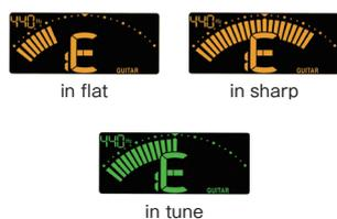
38×16mmの大型LCDモニターを採用。バックライトは自動で2色が切り替わり、明・暗所問わず高い視認性を誇ります。
