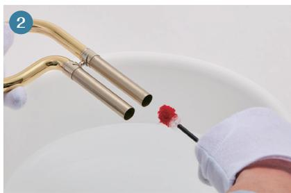
2 フレキシブルクリーナーSにプラスソープ水溶液を含ませ、管内をきれいに洗いましょう。汚れが落ちたら水で十分に洗い流してください。
