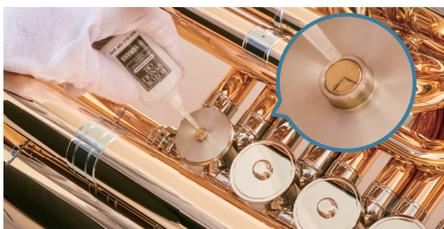
ロータリーバルブのキャップを外し、ローター軸と軸受部の間にロータースピンドルオイルを1~2滴さしてください。裏側のローター回転軸と軸受部にも同様に少量さしてください。はみ出たオイルはガーゼなどで拭き取ってください。
