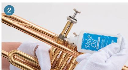
太い部分にオイルを2~3滴さし、真っ直ぐ戻して笠ネジを締め、ピストンを数回動かしてなじませれば完了です。
